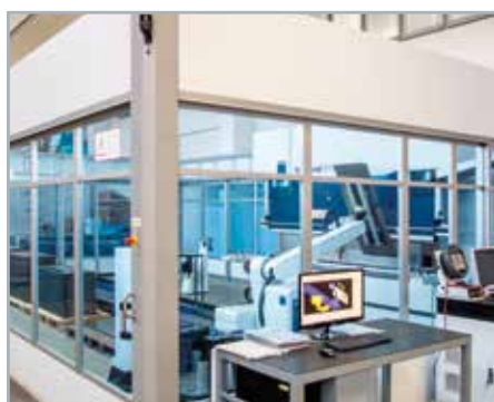
Cella di piegatura automatizzata.
